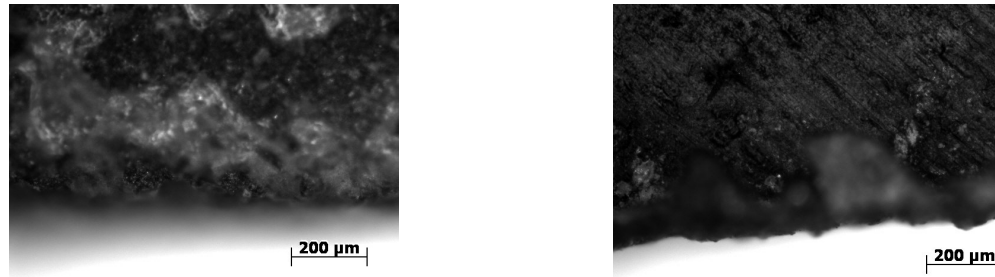
Figura 3.13. Imagini microscopice la marginea dintelui rotoric pentru tolele M400-65A (stânga) și M800-65A (dreapta) debitate cu jet de apă.
